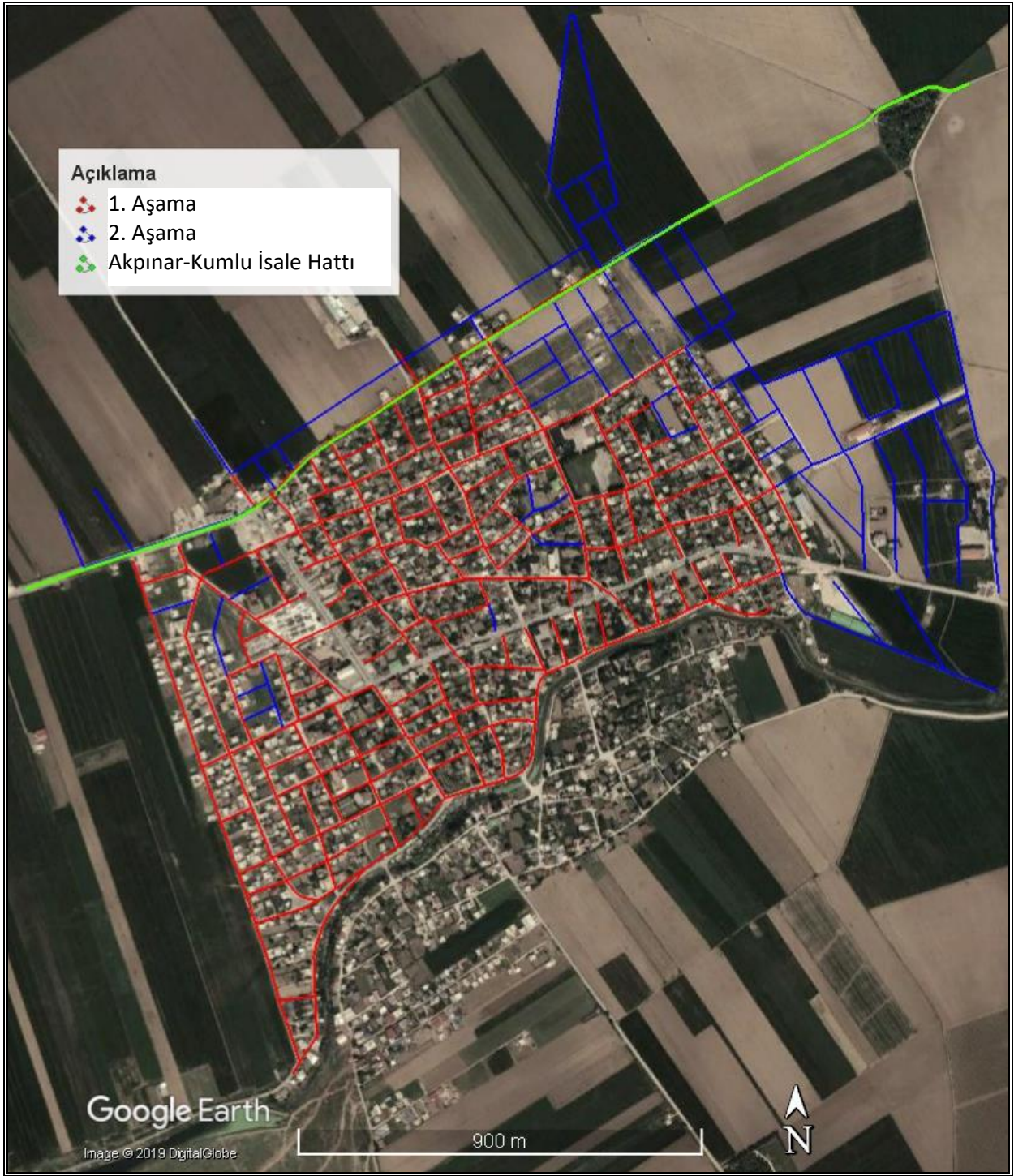
Şekil 4: Kumlu Su Temin Şebekesi Boruları ve İsale Hattının Bölümünün Google Earth Görüntüsündeki Konumları
